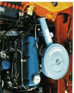
Das ganze Können der Datsun-Ingenieure wurde in die Entwicklung dieses 988 ccm-Kraftpakets gesteckt. Leistungsstark, 4-Zylinder in Reihe, quer zur Fahrtrichtung montiert — mit echten 53 PS (DIN).
