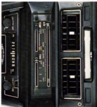
Kartenleuchte, Ventilation, Bedienung Heizung/Detektor
