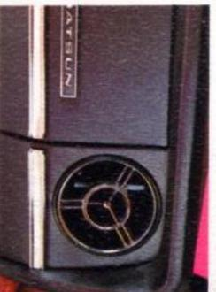
La ventilation permanente Le nouveau système de ventilation intégrale assure une aération permanente de l'habitacle, tout en excluant les courants d'air habituels. Des boucles de ventilation orientables aux extrémités du tableau de bord dirigent l'air frais où vous le désirez. L'évacuation de l'air vicié se fait lui aussi en permanence grâce aux ouïes d'aération situées à hauteur de la custode. Il en résulte un renouvellement continu de l'air dans l'habitacle.
